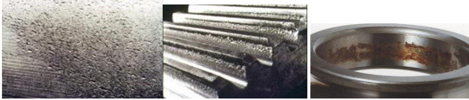
Hình 1.8 Hình thành dạng tróc rỗ bề mặt
